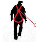
Queda FATOR 2 ponto de ancoragem situado a baixo da conexão dorsal do arnês
