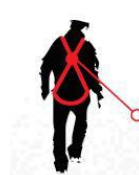
Caída FACTOR 2 el punto de anclaje situado bajo la conexión dorsal del arnés
