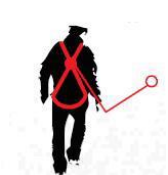
Caída FACTOR 1 punto de anclaje situado al mismo nivel del punto de anclaje dorsal del arnés
