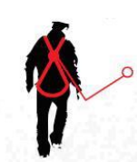
Współczynnik odpadnięcia 1 Punkt kotwiący umiejscowiony na wysokości tylnego punktu kotwiącego szelek bezpieczeństwa
