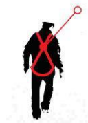
Caduta FATTORE 0 punto di ancoraggio situato sulla testa connessione
