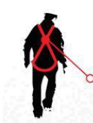
Współczynnik odpadnięcia 2 Punkt kotwiący umiejscowiony poniżej tylnego punktu kotwiącego szelek bezpieczeństwa
