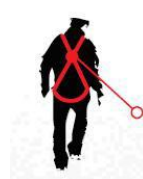
Caduta FATTORE 2 il punto di ancoraggio è situato sotto il punto di ancoraggio dorsale dell'imbracatura
